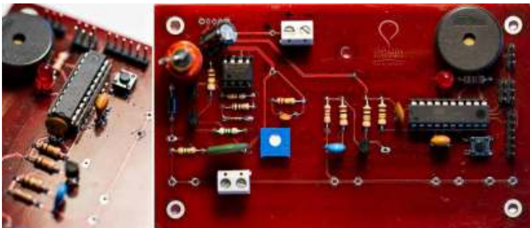
Rys. 41. Płyta licznika GM z wlutowanymi elementami i procesorem Atmega.
