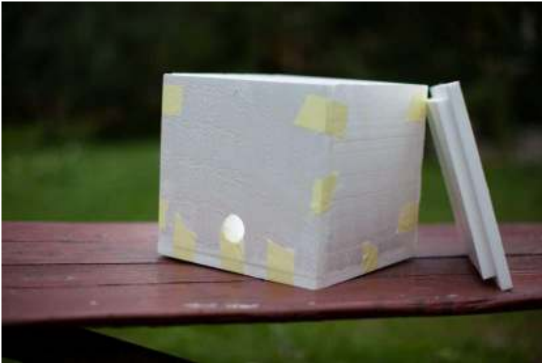
Rys. 26 Gotowa kapsuła wraz z pokrywą i otworami wizyjnymi.
