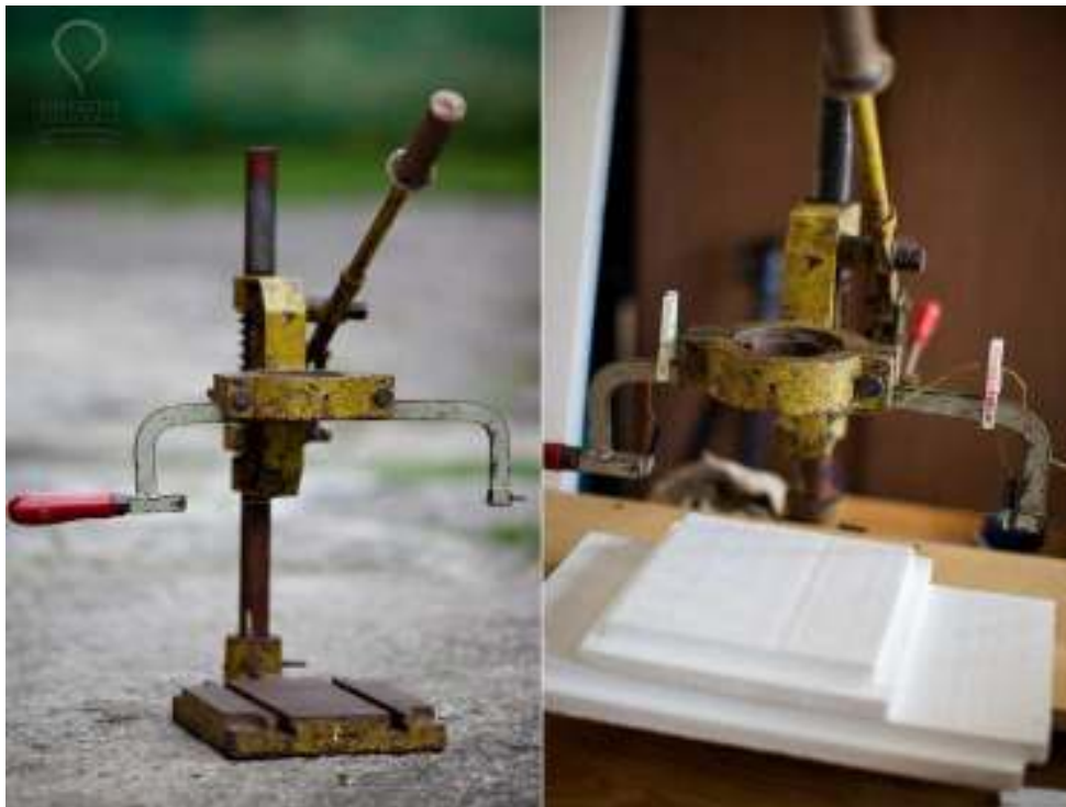
Rys. 22. Prosta wycinarka termiczna do styropianu.
