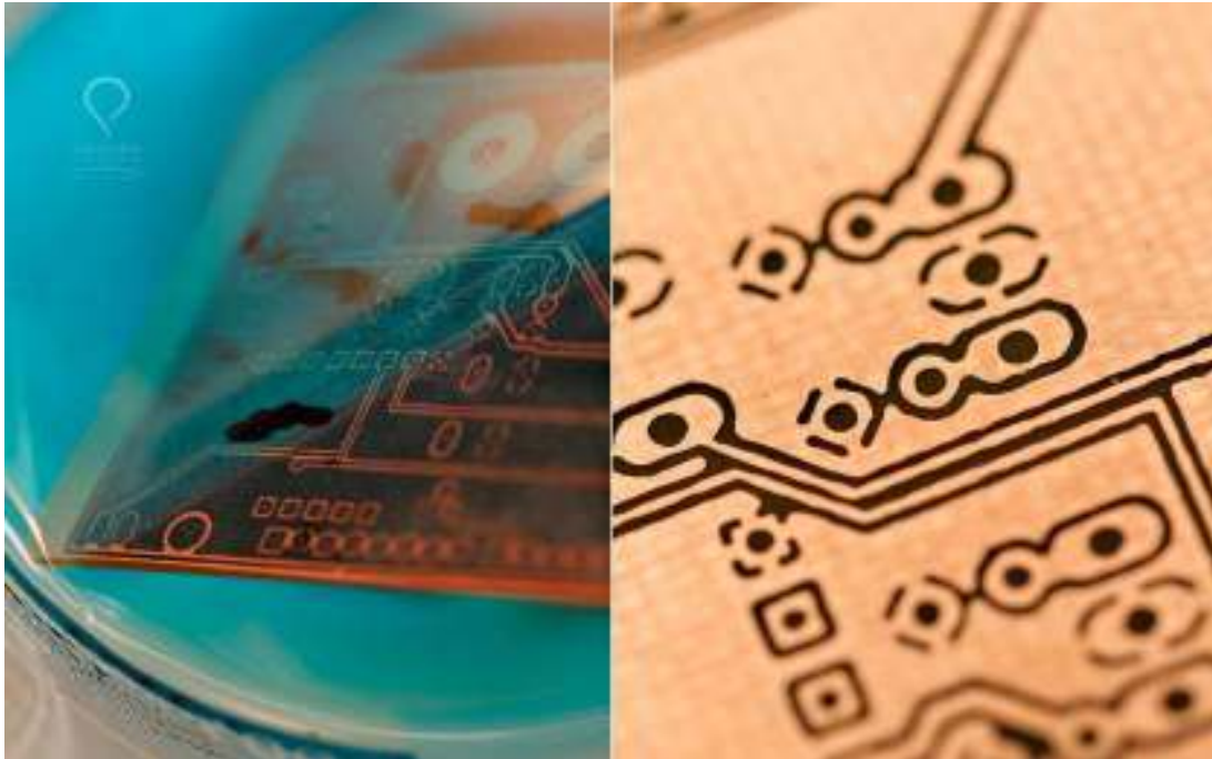
Rys. 43. Proces wytrawiania laminatu komputera pokładowego oraz efekt końcowy procesu.
