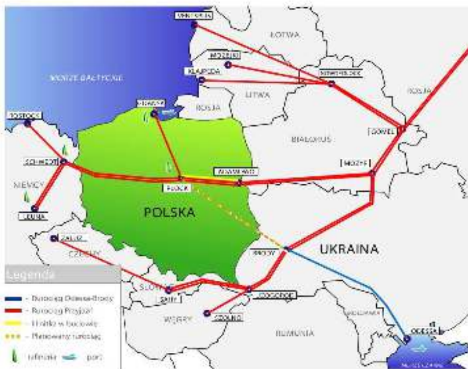
Rysunek 53 Dostawa ropy naftowej do Polski - rozmieszczenie rurociągów.
